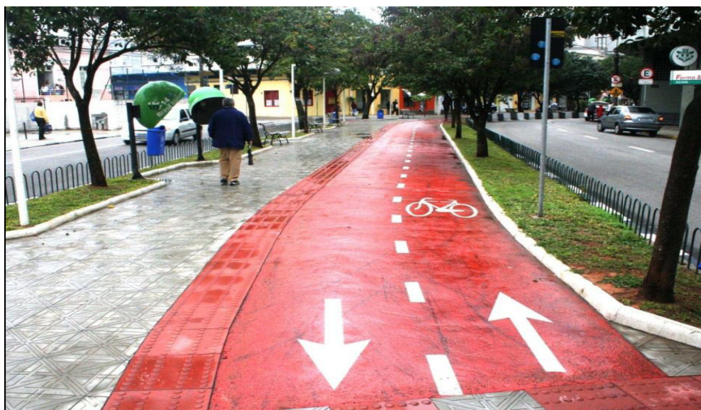
Figura 41: Ciclovias em um canteiro central. A ciclovias utiliza o espaço de calçada, portanto separada das ruas.
